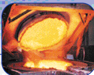
Fusion du corps Monobloc en fonte
